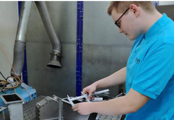
In diesem Beruf fertigen Sie Maschinengehäuse, Verkleidungen, Schutzeinrichtungen oder Be- und Entlüftungsschächte. Dafür wenden Sie verschiedene Trenn- und Umformtechniken, Schweißverfahren und Verbindungstechniken an, um Stahl, Edelstahl und Buntmetalle zu verarbeiten.
